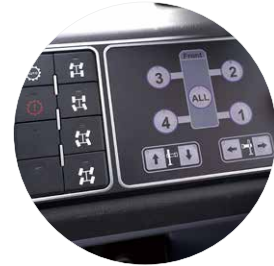
Steering control panel 转向控制面板
